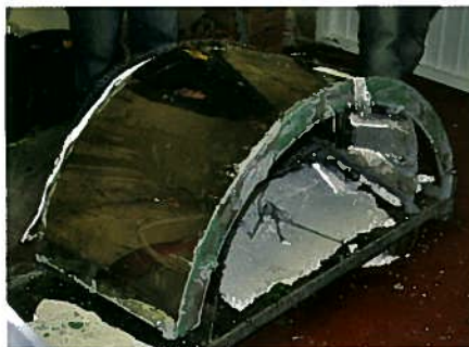
Arriba y derecha: Molde de acero que alberga el agua sólida durante las pruebas de su construcción. Hasta el último día antes de salir la mercancía, no se logró una pieza satisfactoria. Todo un reto para el equipo el proceso de elaboración de la mesa.
